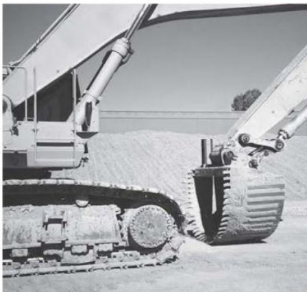
(c) Caçamba especial com fundo arredondado (semicircular) para retroscavadeira
