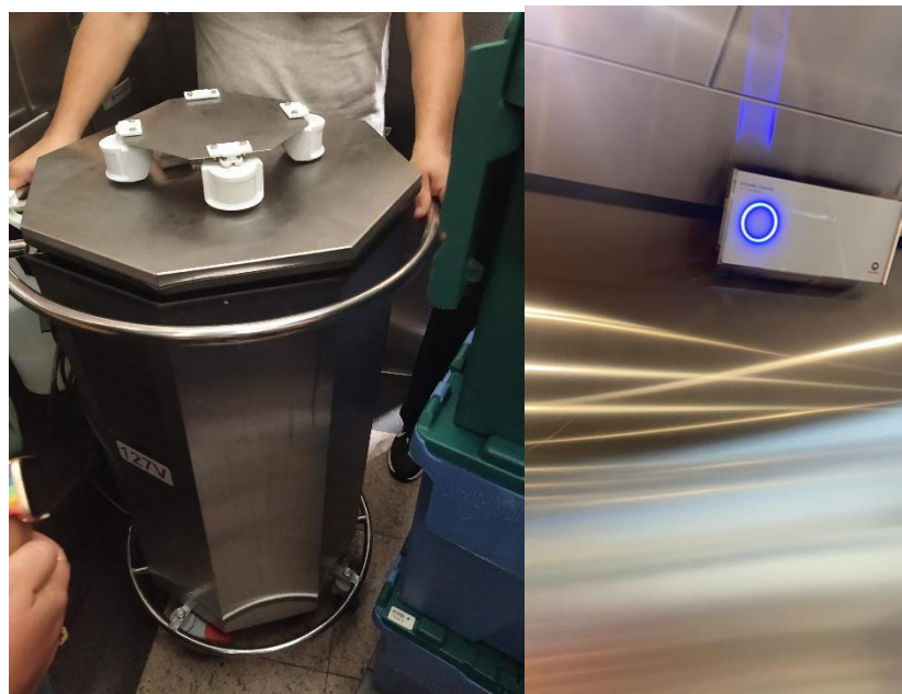
Figura 58- Uso em Hospital filantrópico da cidade de São Paulo de aparelho de Luz UV nos elevadores e equipamento portátil de Luz UV para limpeza de salas. Fonte : Autora, 25 de março 2021
