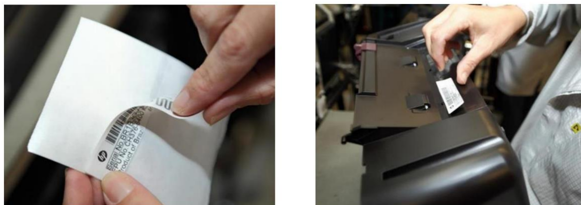
Figura 10 – Detalhe da etiqueta RFID e sua aplicação em um produto
